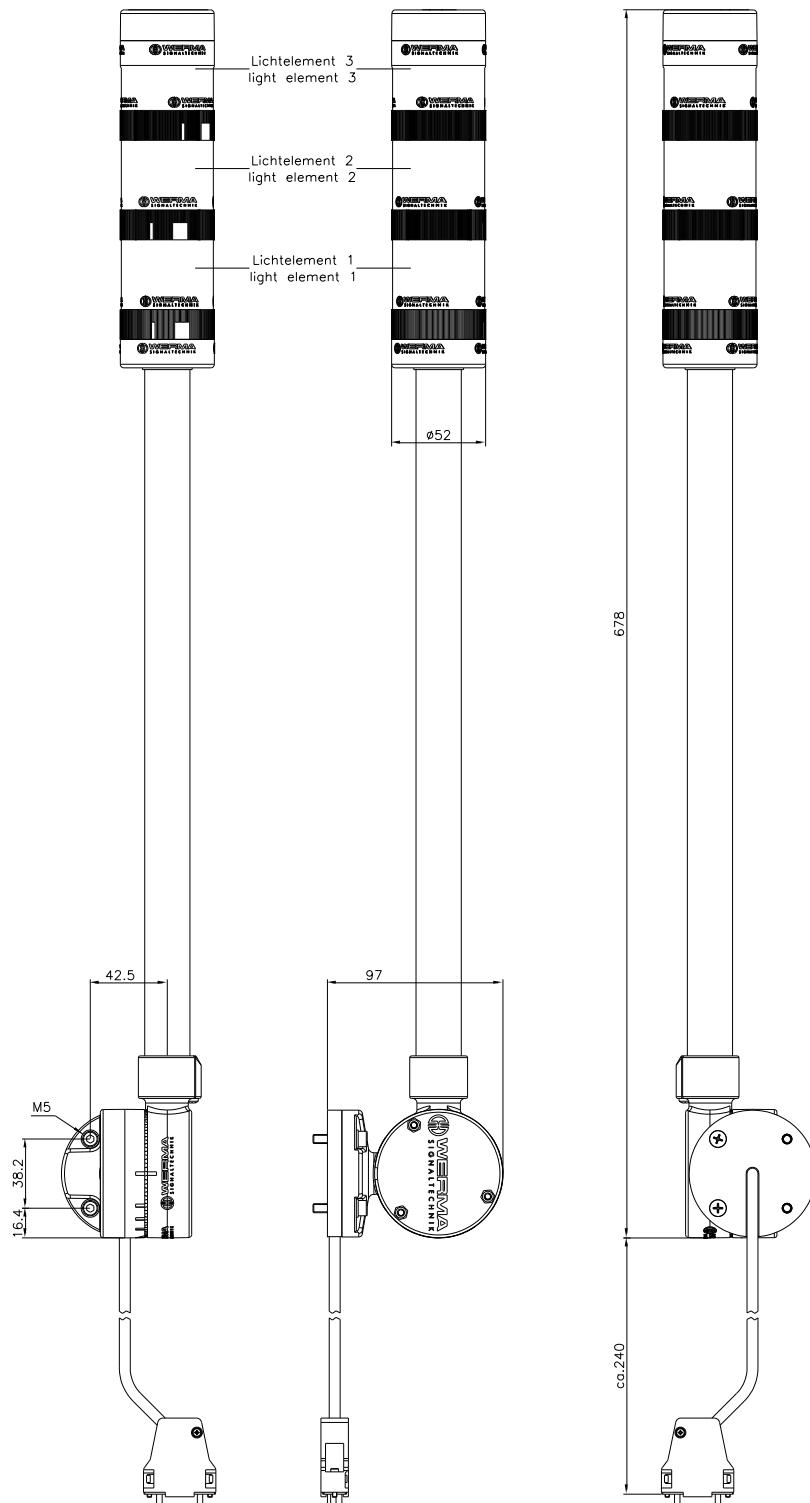
**Abmessungen bei Montage am Gerät**
