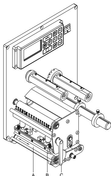
L'enrassement du rouleau de pression peut causer une mauvaise qualité d'impression et peut aussi entraver le transport des matériaux.
