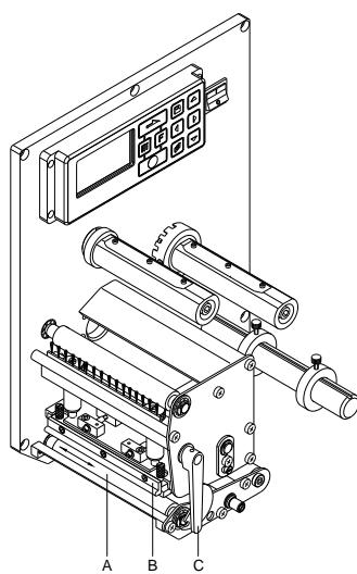
Baskı merdanesinin kirlenmesi, kötü bir baskı kalitesine ve malzeme taşımاسının sınırlanmasına neden olabilir.
