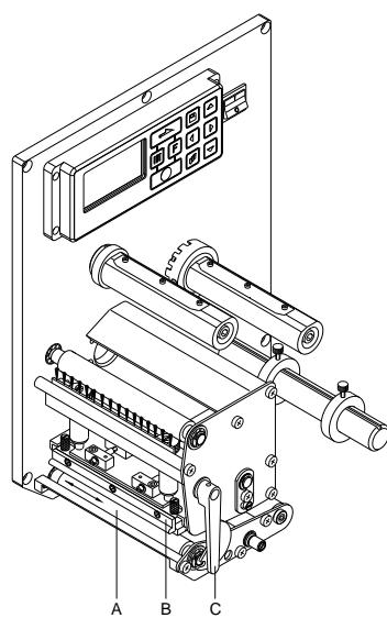
El ensuciamiento del rodillo de presión puede repercutir en una mala calidad de impresión y además puede estropear el material de transporte.
