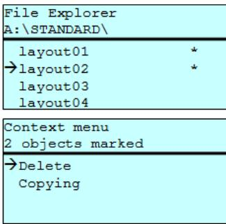
Poistaa yhden tai useampia tiedostoja tai hakemistoja peruuttamattomasti. Hakemistoja poistettaessa poistetaan sekä hakemiston sisältämät tiedostot että alihakemistot.
