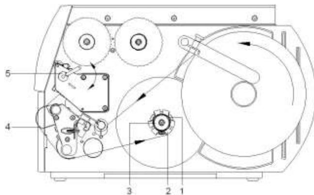
In de opwikkelenmodus worden de etiketten na het bedrukken intern voor het latere gebruik opnieuw opgewikkeld.
