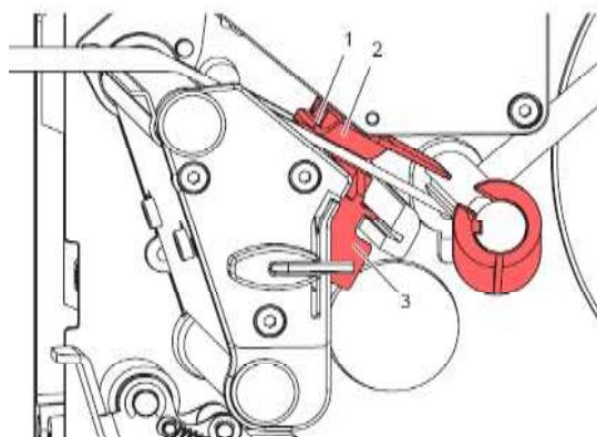
Etiketfotocellen (2) kan forskydes på tværs af papirets løberetning for tilpasning til etiketmaterialet. Fotocellens sensor (1) er synlig forfra gennem printenheden og markeret med en kærv i fotocelleholderen.
