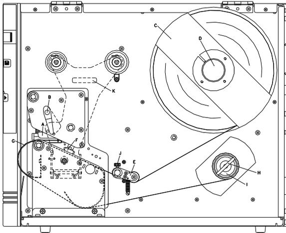
Im Aufwickelmodus werden die Etiketten nach dem Bedrucken intern zur späteren Verwendung wieder aufgewickelt.
