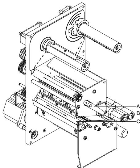
El ensuciamiento del rodillo de presión puede repercutir en una mala calidad de impresión y además puede estropear el material de transporte.
