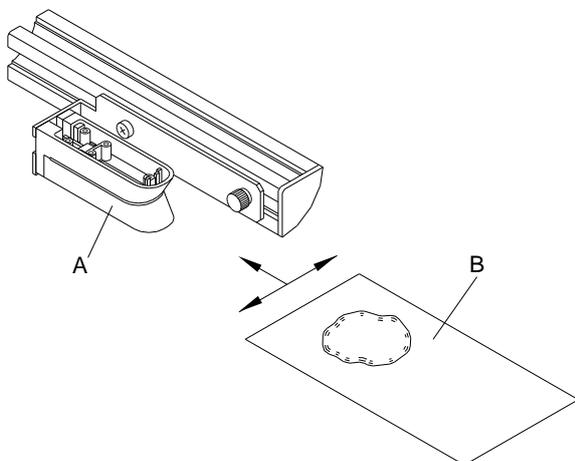
Fotocellsbrytaren kan bli smutsig genom pappersdamm. Därigenom kan identifieringen av etiketternas början påverkas negativt.
