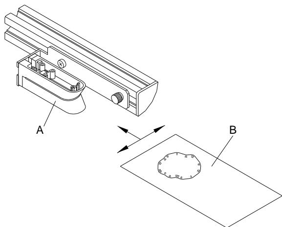
Die Etiketten-Lichtschanke kann durch Papierstaub verschmutzen. Dadurch kann die Etikettenabtastung beeinträchtigt werden.
