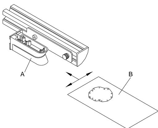
A célula fotoelétrica pode ficar suja com o pó do papel. Isto pode comprometer a deteção das etiquetas.
