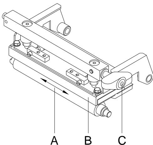
L'encrassement du rouleau de pression peut causer une mauvaise qualité d'impression et peut aussi entraver le transport des matériaux.
