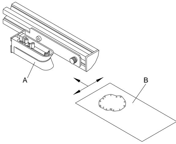
La fotocellula delle etichette può accumulare impurità a causa della polvere di carta. Questo può compromettere il riconoscimento della parte iniziale delle etichette.
