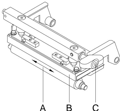
El ensuciamiento del rodillo de presión puede repercutir en una mala calidad de impresión y además puede estropear el material de transporte.
