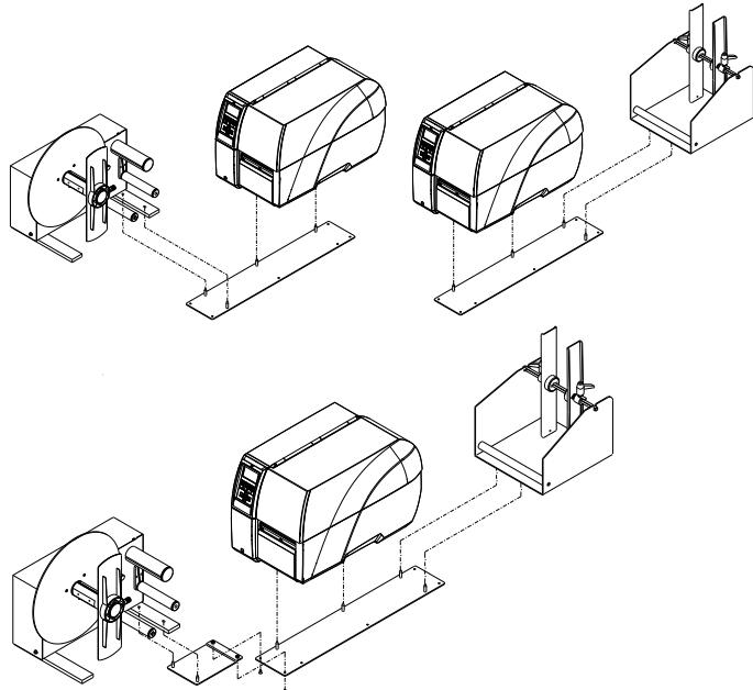
Die Verbindung der PA 50A zum Drucker ist so zu wählen, dass der rechte Gerätedeckel mit der rechten Außenwand der Abwickelvorrichtung bündig ist.
